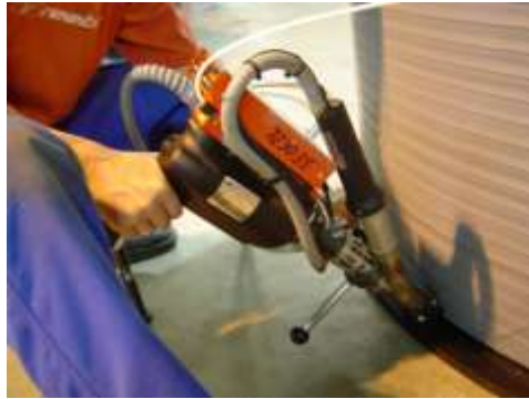
شکل-۴: روش جوش اکستروژن مورد استفاده در ساخت منهولهای پلی اتیلنی
